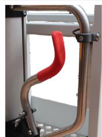
Manette de roulage et bouton de manoeuvre des roues pivotantes
